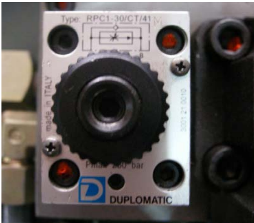
รูปที่ 5 วาล์วจำกัดอัตราการไหลที่ใช้ในการทดสอบ
