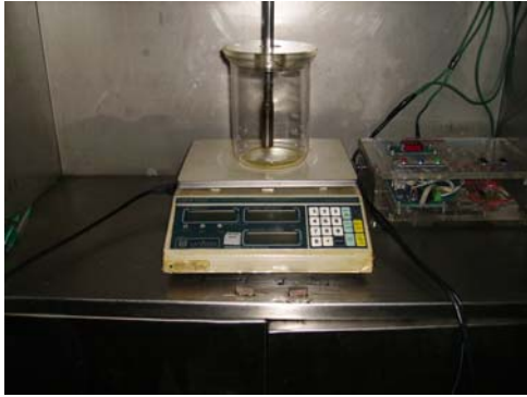
รูปที่ 3 แสดงตาชั่งวัดการสิ้นเปลืองน้ำมันเชื้อเพลิง
