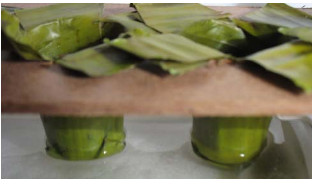
รูปที่ 7 แสดงด้วยใบตองขึ้นรูปด้วยแม่พิมพ์ ที่ช่วงอุณหภูมิ 80-90°C เป็นเวลา 15 นาที โดยใช้แรงกดทับ 1.5-2.0 กิโลกรัม และแช่น้ำยา สารละลาย
