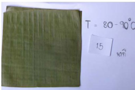
รูปที่ 5 แสดงใบตองที่ช่วงอุณหภูมิ 80-90°C เป็นเวลา 15 นาที
