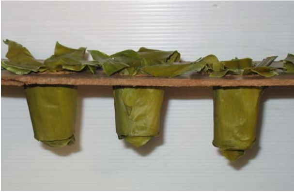
รูปที่ 6 แสดงด้วยใบตองขึ้นรูปด้วยแม่พิมพ์ ที่ช่วงอุณหภูมิ 80-90°C เป็นเวลา 15 นาที โดยใช้แรงกดทับ 1.5-2.0 กิโลกรัม
