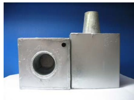
รูปที่ 3 ชุดทดลอง(แม่พิมพ์) ที่ใช้ในการขึ้นรูป
