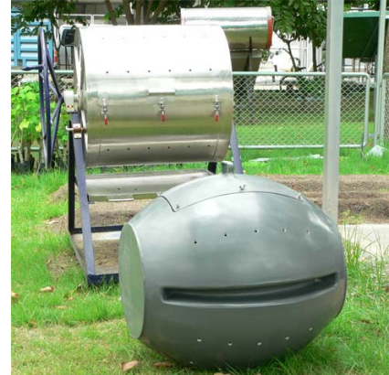
รูปที่ 1 ถังหมักที่ทำด้วยสแตนเลสและถังหมักที่ทำด้วยไฟเบอร์กลาส
