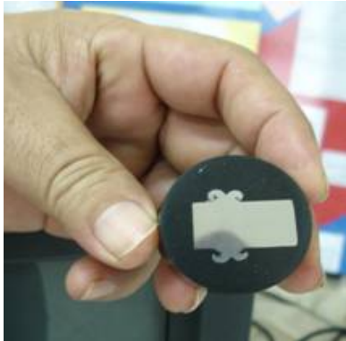
รูปที่ 5 ชิ้นงานที่ผ่านการทำเรือนหุ้มแล้ว
