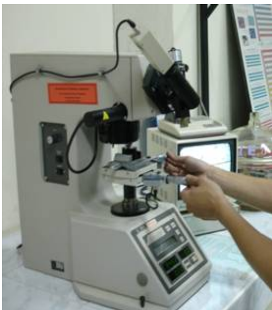
รูปที่ 6 เครื่องวัดความแข็ง ของ Multitoyo รุ่น MVK-H1 Micro Hardness Test
