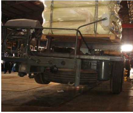
รูปที่ 18 แสดงการยกล้อหน้าด้านขวาของขึ้นเหนือจากพื้น 20 ซม. (สภาวะรวมโมเมนต์ดัดและแรงบิด)
