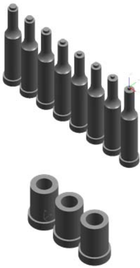
รูปที่ 4 แสดงการออกแบบลักษณะฟันซ์ และดายส์
