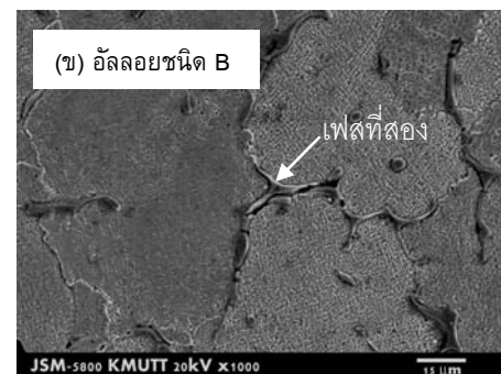
รูปที่ 2 โครงสร้างจุลภาคของชิ้นงานหล่อโลหะเงินสเตอร์ลิง
