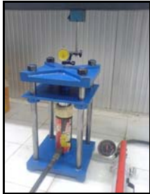
รูปที่ 3.3 การติดตั้งแม่แรงและชุดไดอัลเกจ
