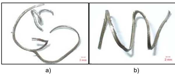
รูปที่ 11 แสดงเศษกึ่งที่ได้จากการทดลอง a) มีดกึ่ง R_a = 1.55 \mu m b) มีดกึ่ง R_a = 0.06 \mu m
