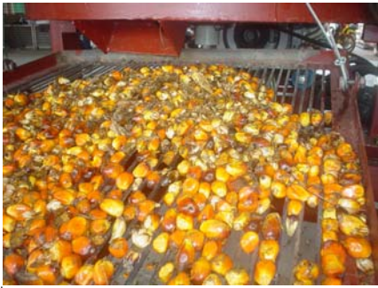
รูปที่ 12 เมล็ดผลปาล์มออกมายังช่องทางออกลงสู่ตระแกรงร่อน
