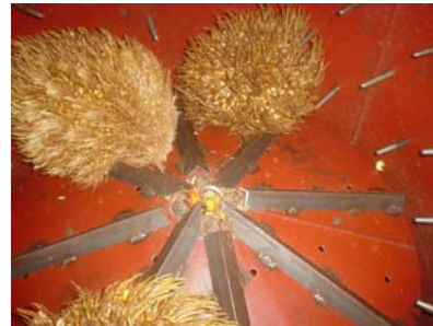
รูปที่ 11 ทะลายปาล์มขณะกำลังทำการแยกผลปาล์มออกมา
