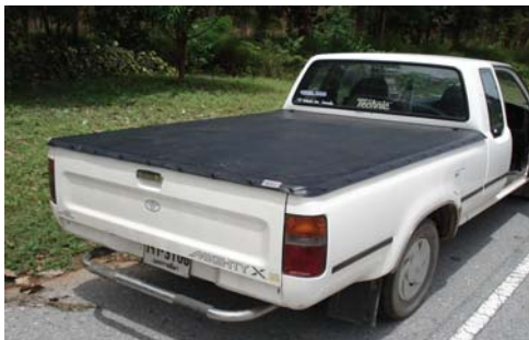
รูปที่ 10 รถกระบะที่มีการปิดช่วงกระบะท้ายสำหรับใช้ทดสอบ
