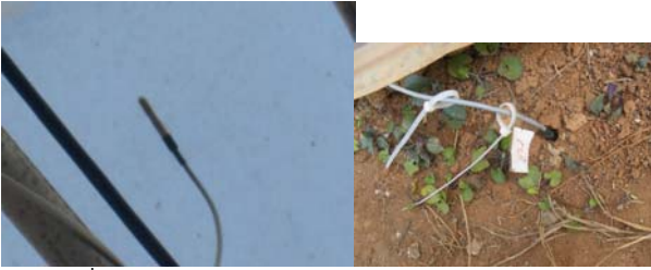
รูปที่ 5 แสดงอุปกรณ์วัดอุณหภูมิ ณ บริเวณหลังคาและใต้ดิน
