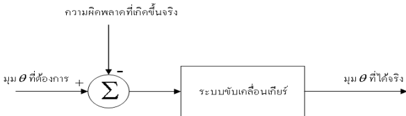
รูปที่ 4.1 วิธีการลดความผิดพลาดที่เกิดขึ้นในเกียร์[3]
