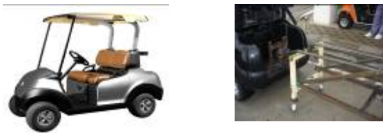
รูปที่ 5 รถกอล์ฟที่ใช้ในการทดลอง (ซ้าย) การติดตั้งติดกับ rolling straightedge (ขวา)
