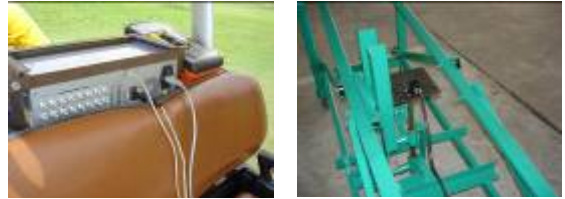
รูปที่ 6 ภาพตำแหน่งการวาง data locker (ซ้าย) การติดตั้ง Accelerometer ติดกับ rolling straightedge (ขวา)
