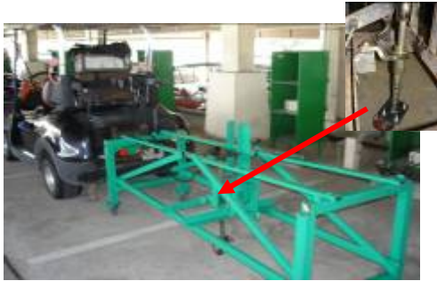
รูปที่ 3 แสดงลักษณะของ Rolling straightedge และตำแหน่งสปริง
