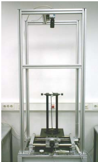
รูปที่ 6 ชุดทดลองระบบลูกตุ้มกลับหัว 3 มิติ
