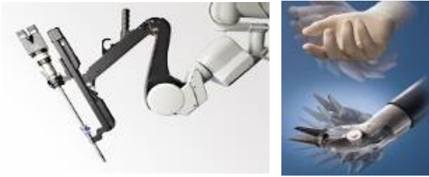
รูปที่ 1 แขนกลตามในระบบผ่าตัดดาร์วินซี [1]
