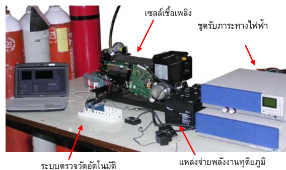
รูปที่ 1 ชุดทดลองระบบขับเคลื่อนเซลล์เชื้อเพลิงแบบไฮบริด
