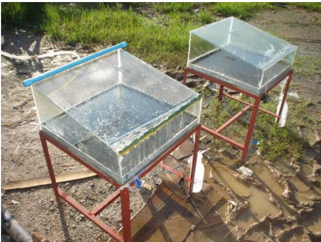
รูปที่ 4 เครื่องกลั่นน้ำพลังแสงแดดทั้งสองแบบที่ทำการติดตั้งและกำลังทำงาน
