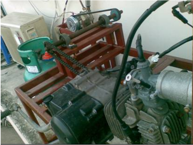
รูปที่ 3 การติดตั้งเครื่องยนต์ขับเคลื่อนคอมเพรสเซอร์
