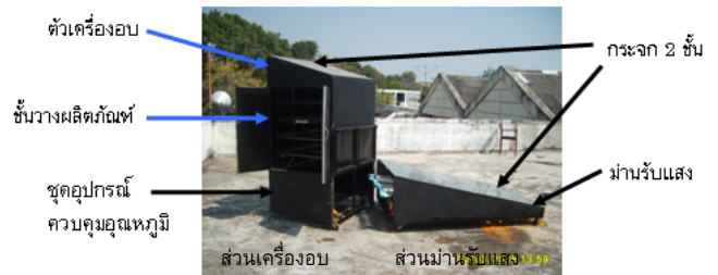
รูปที่ 2 แสดงลักษณะของเครื่องอบ ชั้นวาง และอุปกรณ์ที่ติดตั้งในเครื่องอบพลังงานแสงอาทิตย์ [3]
