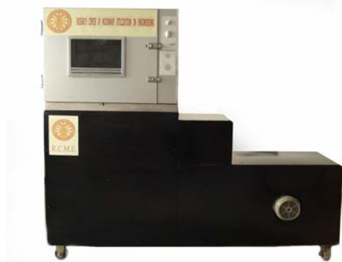
รูปที่ 3 ภาพถ่ายจริงของเครื่องอบแห้งข้าวเปลือกเชิงพาณิชย์ โดยใช้คลื่นไมโครเวฟร่วมกับระบบสเปาเต็ดเบต ชนิดป้อนคลื่นสองตำแหน่ง
