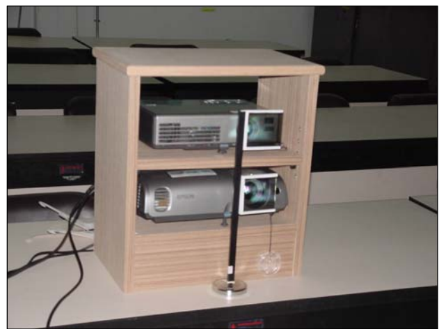
รูปที่ 5 การจัดวางเครื่องฉายภาพและแผ่นกรองแสงแบบโพลาไรซ์
