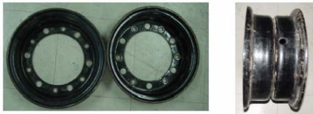
รูปที่ 2 กระทะล้อแบบสองชีก
