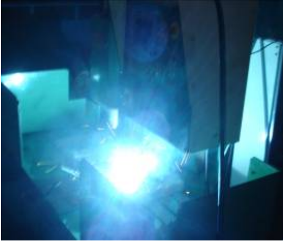
รูปที่ 6 การเติมเนื้อวัสดุด้วยวิธีการเชื่อม MIG/MAG (Metal Inert Gas/Metal Active Gas) ตาม NC-CODE
