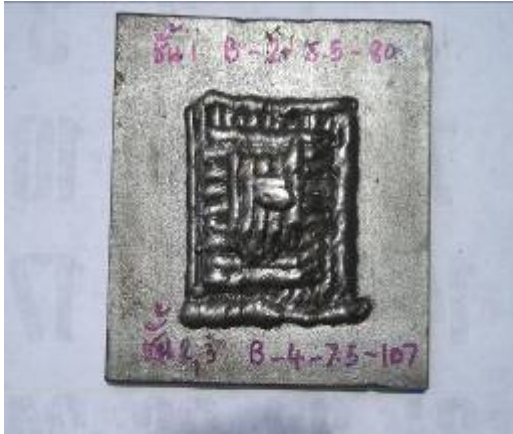
รูปที่ 2 การเติมเนื้อโลหะในชิ้นงานเพื่อเข้าสู่กระบวนการทดสอบความแข็งแบบร็อคเวลล์ (Rockwall Hardness Tester)
