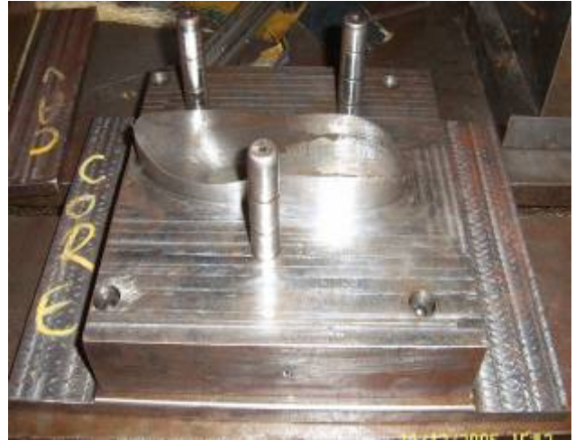
รูปที่ 12 แผ่นแม่พิมพ์ส่วนตัวผู้ (Core Plate) ที่ผ่านกระบวนการกัดเรียบร้อยแล้ว
