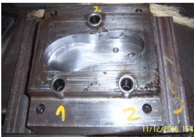
รูปที่ 11 แม่พิมพ์ส่วนตัวเมีย (Cavity Plate) ที่ผ่านกระบวนการกัดเรียบร้อยแล้ว
