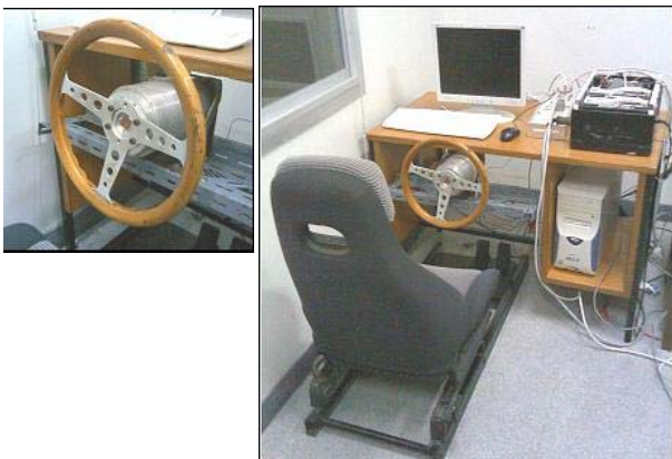
รูปที่ 8 Torque feed back steering system และ ระบบจำลองการขับชี่ หลังจากติดตั้งระบบเพิ่ม Road feeling
