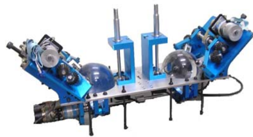
รูปที่ 2 รูปต้นแบบจริงของอุปกรณ์ส่งถ่ายความเร็วแบบปรับอัตราทดได้ ต่อเนื่อง Double CVT
