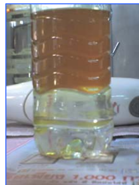
รูปที่ 2 แสดงการแยกชั้นหลังการผสมระหว่างปาล์มไบโอดีเซลกับน้ำ
