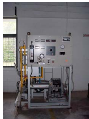
รูปที่ 1 ชุดทดสอบสมรรถนะของเครื่องยนต์ดีเซลขนาดเล็ก
