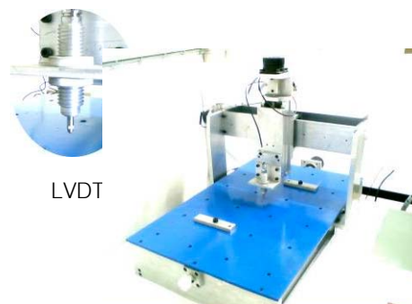
รูปที่ 3 เครื่องมือวัดอัตราการถ่ายเทมวลของผิวทดสอบแบบอัตโนมัติ 3 แกน (X-Y-Z Table)
