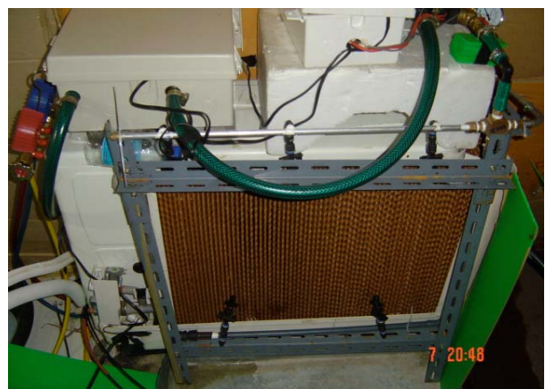
รูป 7 คอนเดนซิ่ง ยูนิท ขนาด 10000 บีที่ยูต่อชั่วโมง
