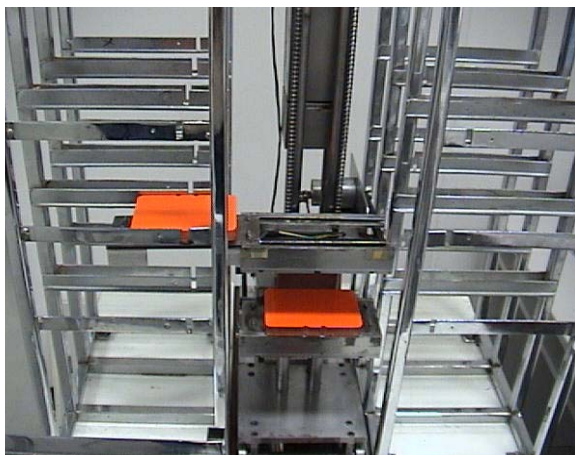
รูปที่ 1 ชุดเครื่องจักรเก็บสินค้าแบบทำงานต่อเนื่อง 2 ระดับ
