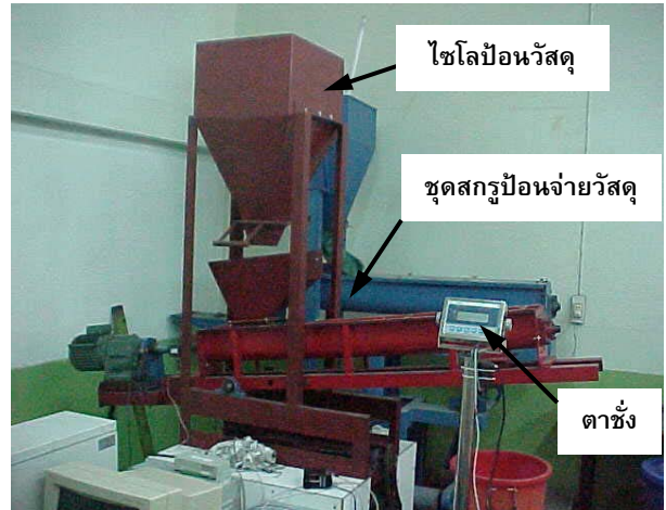
รูปที่ 1 ชุดทดลองหาอัตราการขนถ่ายวัสดุของอุปกรณ์ป้อนจ่ายวัสดุด้วยใบสกรูที่ใช้ในการวิจัย
