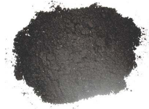
รูปที่ 1 ลักษณะผงถ่านวัตถุดิบที่ผ่านการบด
