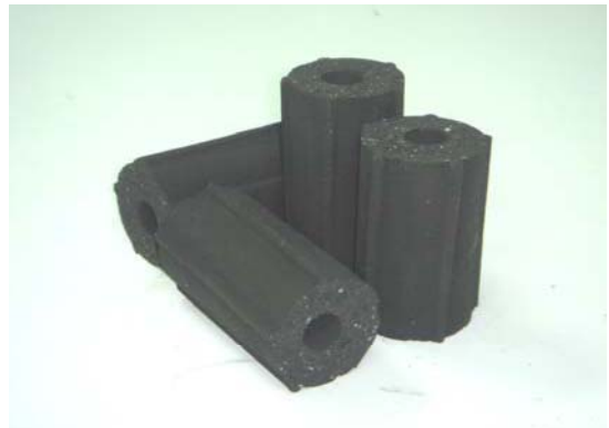
รูปที่ 4 ลักษณะของแท่งเชื้อเพลิงจากถ่านไม้ยางพาราที่ผลิตได้
