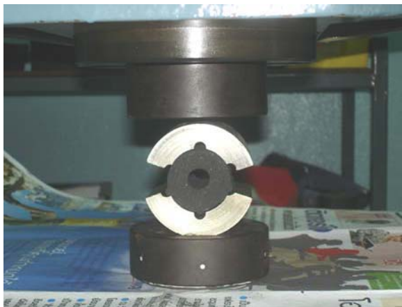
รูปที่ 5 การวางแท่งเชื้อเพลิงในการทดสอบการต้านทานแรงกด
