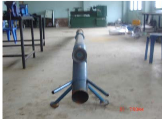
รูปที่ 1 ท่อสูบน้ำที่ใช้เป็นภาระให้กับเครื่องยนต์
