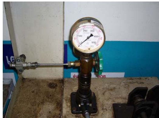
รูปที่ 6 แสดงวิธีการทดสอบแรงดันชุดหัวฉีด
