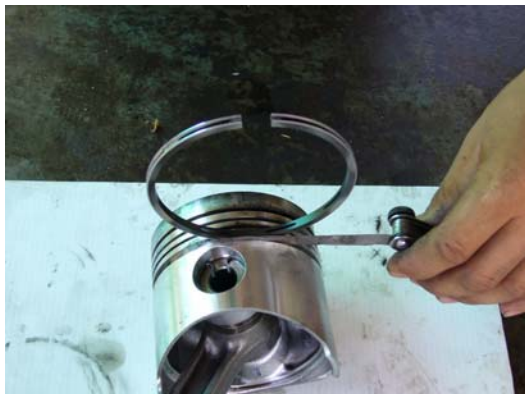
รูปที่ 4 แสดงวิธีการวัดช่องว่างระหว่างแหวนกับร่องแหวนลูกสูบ
