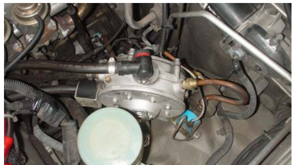
รูปที่ 4 แสดงการติดตั้งระบบลดความดันแก๊สก่อนเข้าเครื่องยนต์
