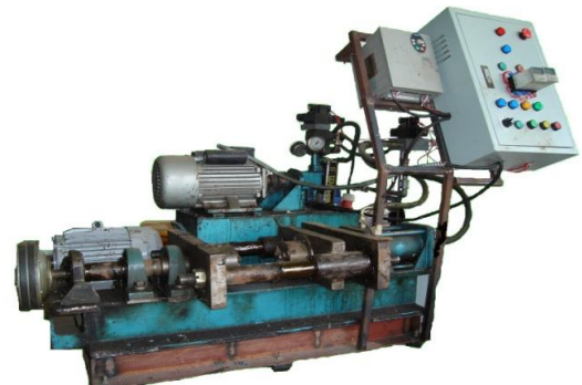
รูปที่ 2 เครื่องเชื่อมด้วยความเสียดทานที่ใช้เพื่อการทดลอง
