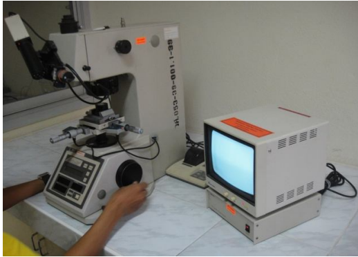
รูปที่ 8 แสดงเครื่องวัดความแข็ง ของ Multitoyo รุ่น MVK-H1 Micro Hardness Test
