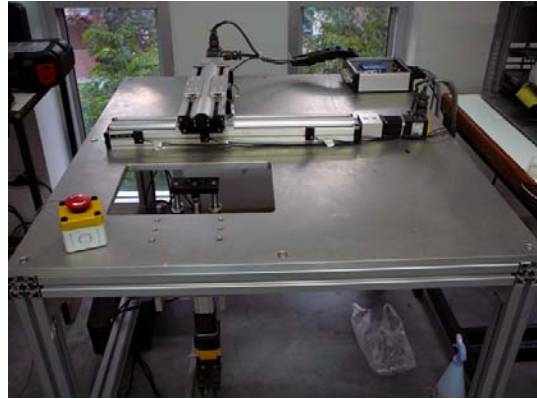
รูปที่ 2 แทนเครื่องพิมพ์ที่ประกอบไปด้วยแกนเคลื่อนที่สามแกน และเครื่องสัมพันธ์ตำแหน่งตรงบริเวณมุมบนขวาของแท่นพิมพ์
