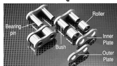
รูปที่ 1. แสดงส่วนประกอบของโซ่ลูกกลิ้ง[5]
