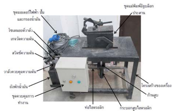
รูปที่ 1 เครื่องอัดอิฐบล็อกประสานระบบไฮดรอลิก
