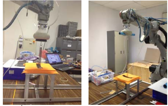
รูปที่ 9 การทดสอบแรงในการยืดจับของวัตถุครึ่งทรงกลมและทรงกระบอกกลวงด้วยสปริงวัดแรงดึง
