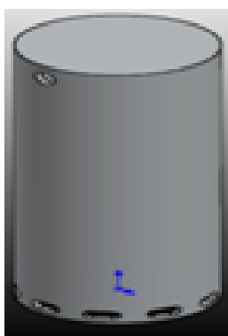
รูปที่.10 การออกแบบลูกสูบ( Cylinder ) โดยใช้วัสดุคือเหล็กASTM 306 ด้วยความดันสูงสุดที่ 0.10 Mpa.[6]
