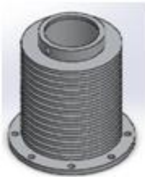
รูปที่ 9. การออกแบบกระบอกสูบและระบบระบายความร้อนโดยใช้อากาศเป็นตัวระบายความร้อนในส่วนนี้จะสามารถรองรับความดันสูงสุดคือ 0.10 Mpa.
