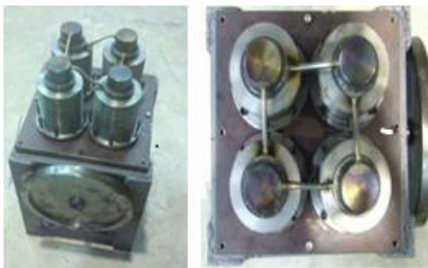
รูปที่ 6. Structure of Alpha-Type double acting Stirling engine.
