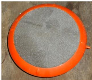
รูปที่ 5 ตัวกำเนิดฟองอากาศแบบแผ่นวัสดุพรุนที่ใช้ในการทดลอง
