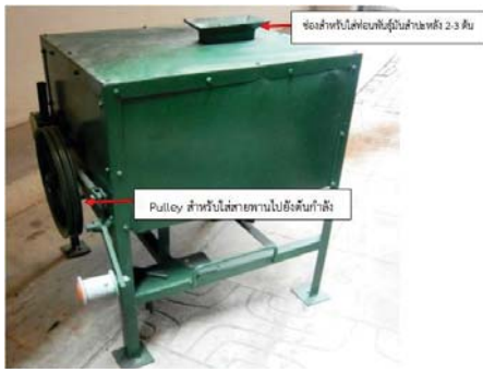
รูปที่ 5 เครื่องตัดท่อนพันธุมันสำปะหลังแบบตัดต่อเนื่องสำหรับใช้ในชุมชน
