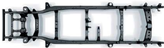
รูปที่ 2 โครงสร้างแชสซิสเดิมของรถโตโยต้ารีโว่
