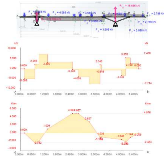
รูปที่ 3 แผนภาพโหลดที่กระทำบนโครงสร้างแชสซิส ค่าแรงเฉือนและโมเมนต์ดัด
