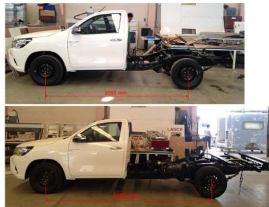
รูปที่ 1 รถที่มีระยะฐานล้อเดิม (บน) และ รถที่มีการเพิ่มระยะฐานล้อใหม่ (ล่าง)
