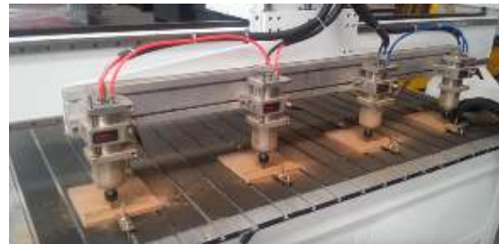
รูปที่ 1 ซีเอ็นซีแบบหลายหัวกัดเคลื่อนที่พร้อมกันในแกน Z
