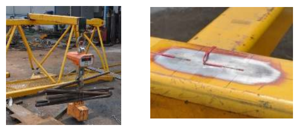
รูปที่ 2 การวัดค่าความเค้นด้วยเกจวัดความเครียด
