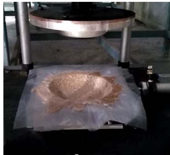
รูปที่ 7 แสดงการขึ้นรูปภาชนะจากเส้นใยผักตบชวา
