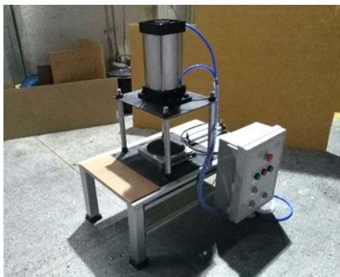
รูปที่ 4 เครื่องขึ้นรูปภาชนะที่ทำจากวัสดุธรรมชาติ
