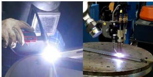
รูปที่6 การเชื่อมด้วยการอาร์คพลาสมา PAW [24]
