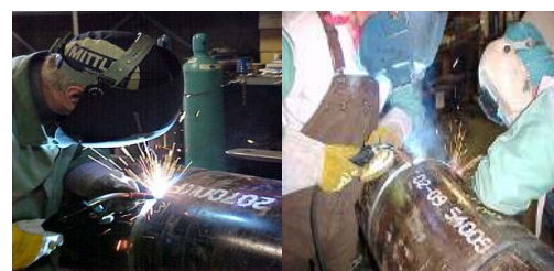
รูปที่9 รูปแสดงการเชื่อมที่มีแนวเชื่อมรอบวงท่อ [26]
