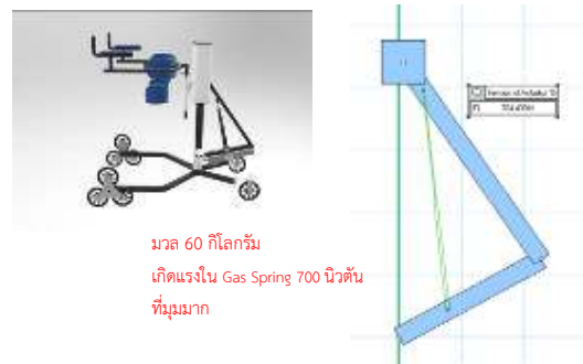
รูปที่ 12 การปรับมุม เพื่อให้เกิดน้ำหนักที่พยุงมากที่สุด
